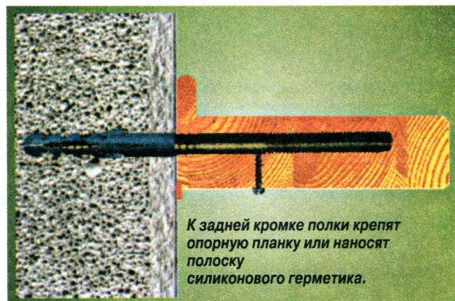
Клей, залитый в отверстия, удерживает нагруженную полку вплотную к стене.
