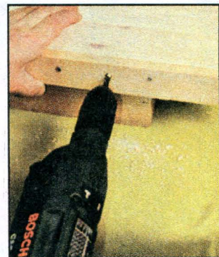
Резьбовую муфту с отрезком шпильки зажимают в патроне электродрели
